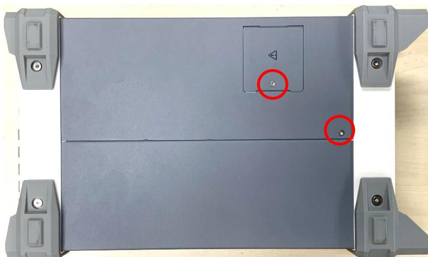
3、使用 T10 内梅花螺丝刀拆下固定前后输入插孔的 4 颗螺丝并且取下侧边的 8 颗固定螺丝，即可取下前后面板总成，如图所示：
