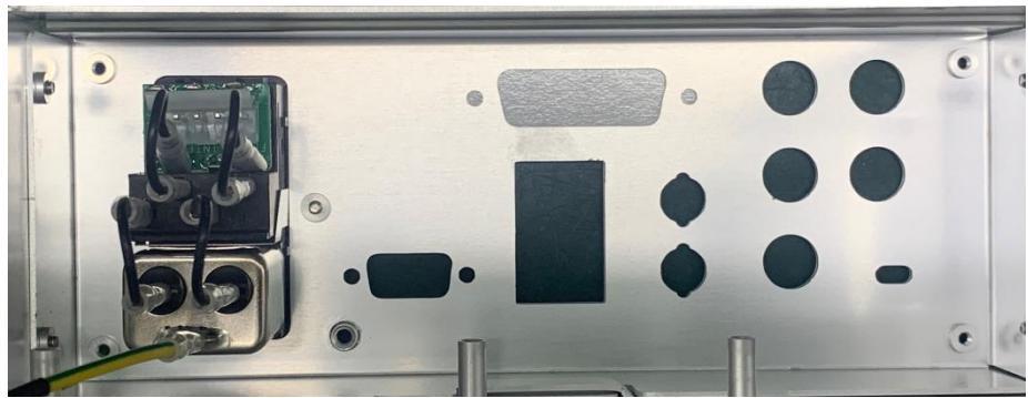
3、使用 T10 内梅花螺丝刀拆下固定后壳与电源插座的 2 颗螺丝，如下图：
