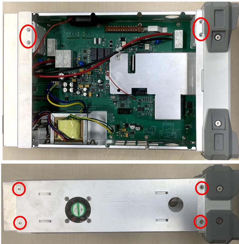
4、使用 T10 内梅花螺丝刀拆下固定面框的 4 颗螺丝，如图所示：
