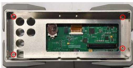
5、使用 T10 内梅花螺丝刀拆下固定面框的 9 颗螺丝，如图所示：
