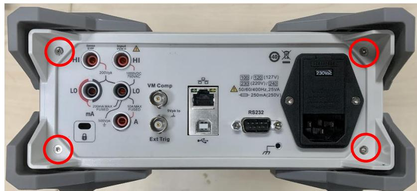
2、使用 T10 内梅花螺丝刀拆下固定底部 2 颗螺丝，即可取出机箱外壳，如图所示：
