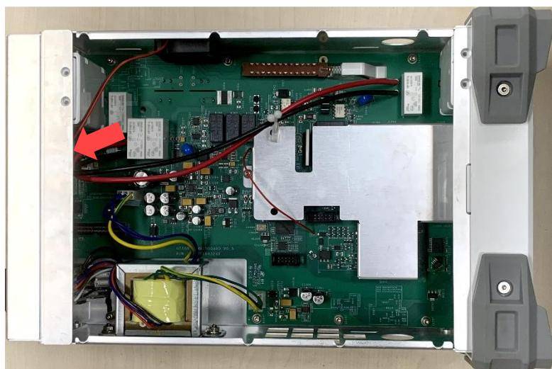
2、使用 T10 内梅花螺丝刀拆下中框组件固定风扇的 4 颗螺丝，如图所示：
