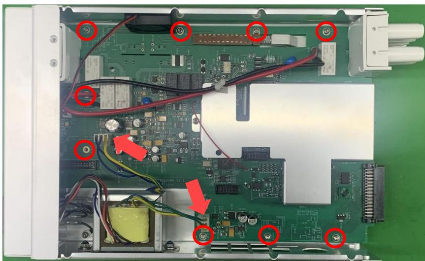
3、使用 T10 内梅花螺丝刀拆下主板屏蔽罩上的 1 颗螺丝，取出主板维修或更换部分元器件，如图所示：
