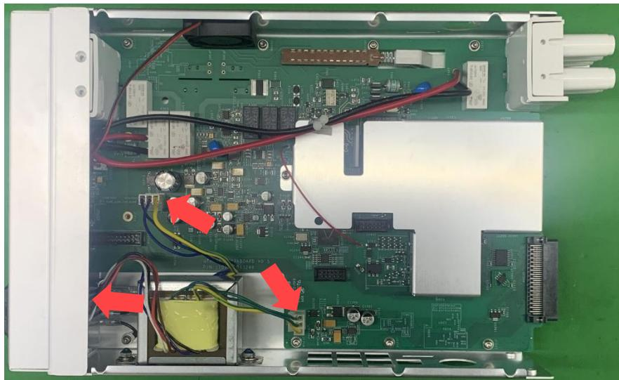
2、使用 T10 内梅花螺丝刀和尖嘴钳拆下中框组件固定风扇的 2 颗螺丝，如图所示：
